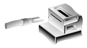
Die Zuführung der Sekundärleitungen zu den Anschlussklemmen wird normalerweise durch die rechteckigen Öffnungen an der Vorder- und Rückseite vorgenommen. Bei der Montage z.B. hinter Sicherungsleisten erfolgt der Sekundäranschluss mittels Kabelschuhen durch die **seitlichen Schlitze**.
